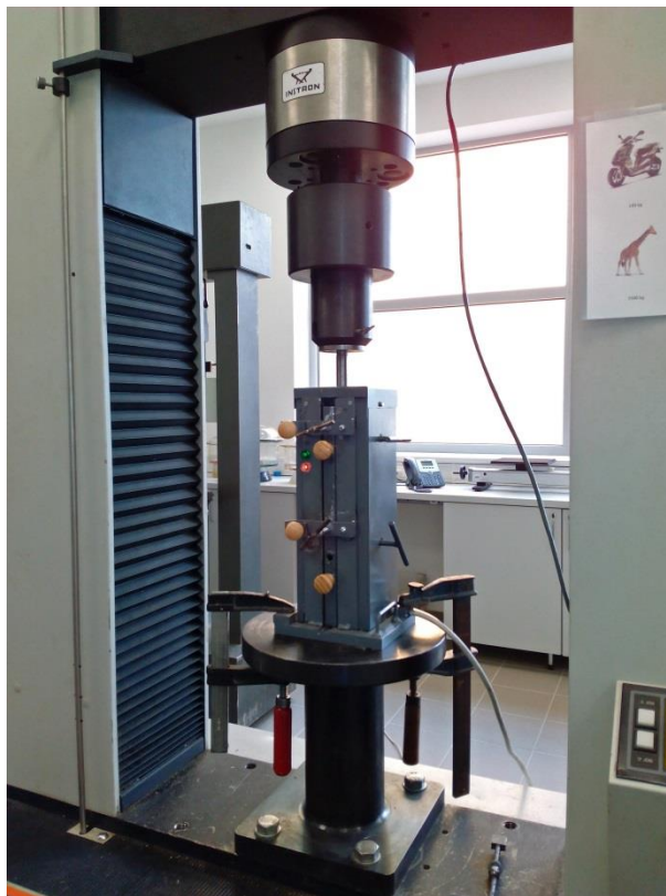
1. ábra Tömörítő gép a Faanyagtudományi Intézet laboratóriumában
